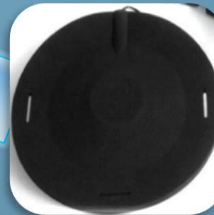
Galette : Appareil à l'intérieur duquel se trouve un accéléromètre triaxial servant à mesurer les vibrations reçues par le salarié au niveau de l'assise
